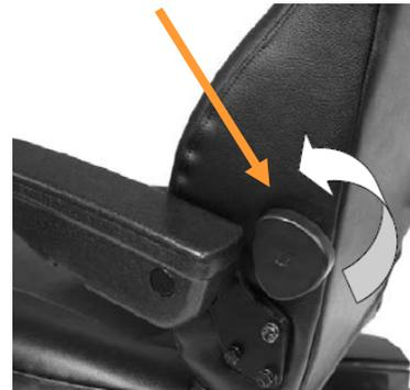
Palanca ajuste inclinación del respaldo
