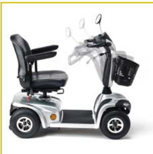
Columna de conducción
